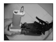
REMOVE THE MAGAZINE ASSEMBLY (039) AND PLATE (016).
