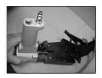
REMOVE THE MAGAZINE ASSEMBLY (039) AND PLATE (016).
