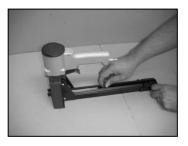
PULL PUSHER (034) BACK TO UPRIGHT POSITION AND GENTLY LET THE PUSHER (034) SLIDE FORWARD AGAINST THE STAPLES. DO NOT LET THE PUSHER (034) SLIDE FORWARD AND STRIKE THE STAPLES AT HIGH SPEED FOR THIS MAY DEFROM THE STAPLES OR DAMAGE THE TOOL.
