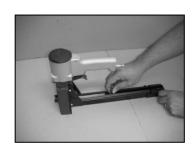
PULL PUSHER (034) BACK AND ROTATE TO LOCKED POSITION .
