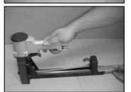
INSERT 2 STICKS OF APPROPRIATE STAPLES INTO THE MAGAZINE (039) FROM BACK . LET THE STICKS SLIDE FORWARD TO THE FRONT OF THE MAGAZINE (039) .
