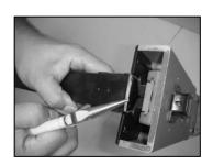
INSERT LONG NOSE PLIERS OR SCREW DRIVER TO CLEAR JAM.
